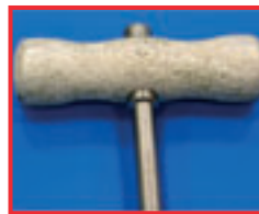
Attaque du matériau uni, sur la poignée en aluminium. Raison : Traitement avec un nettoyant fortement alcalin
