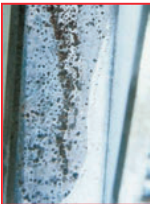
Dépôts d'un agent caustique contenant des chlorures sur un instrument
