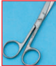
Ciseaux avec piqûre de corrosion
