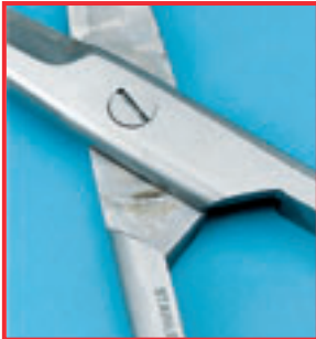
Corrosion de friction par suite d'un manque d'entretien à l'huile
