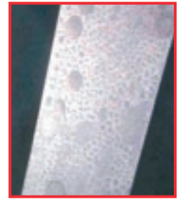
Surface d'instrument avec décolorations en forme de gouttelettes
