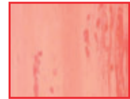
Attaque du matériau; Raison: Nettoyant alcalin
