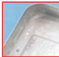
Attaque de matériau . Raison : Traitement avec nettoyant alcalin
