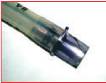
Fissure due à la contrainte
