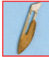
Rouille sur une lame de scalpel. Raison : Choix du matériau, pas acier inox, car produit à emploi unique.
