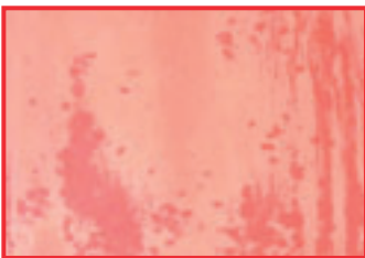
Modification optique de l'aluminium anodisé et coloré même en présence d'une alcalinité minimale
