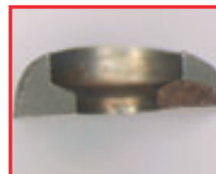
Surface de cassure dans le logement d'alésage pour la tête de vis
