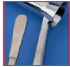
Taches en raison de la teneur en sel trop élevée dans l'eau de rinçage
