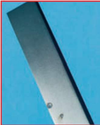
Attaque de corrosion sur ciseaux
