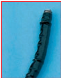
Gonflement à l'extrémité distale d'un fibroscope
