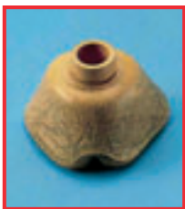
Fissure de vieillissement sur un masque respiratoire
