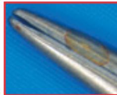
Attaque acide des soudures et des couche intermédiaire de métal avec forte usure, suite au dommage. Raison : Surdosage
