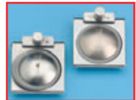
Soupape à clapet non étanche d'un trocart par gonflement des joints suite au contact avec de l'huile.
