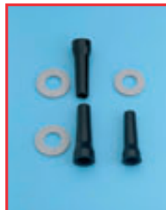
Joints gonflés suite à l'application non ciblée d'huile pour instruments.
