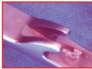
Branche du porte-aiguille avec point de friction dû au ressort
