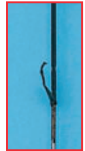
Isolation endommagée sur un instrument HF
