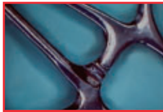
Détail de pince: blocage et zone annulaire
