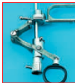
Attaque du matériau uni, sur les composants en aluminium. Raison : Traitement avec un nettoyant fortement alcalin
