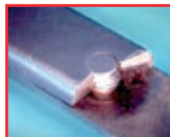
Ciseaux avec cassure dans le filetage
