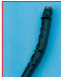
Tuyau d'introduction gonflé suite à l'emploi d'un produit d'entretien inadéquat.
