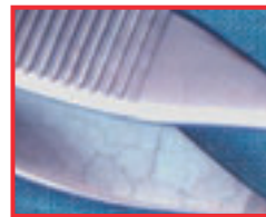
Décoloration de l'instrument avec auréoles de taches
