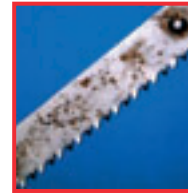
Dépôt de rouille sur une lame de scie chromée en acier non allié. Raison : Défaut partiel de la couche chromée.
