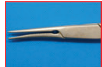
Déformation due à une manipulation non conforme
