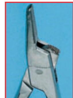
Cassure de la mâchoire d'un porte-aiguille en métal dur
